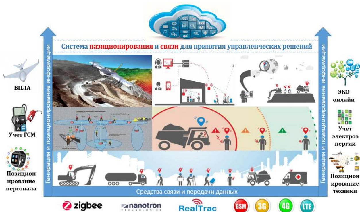
Рисунок 8 – Концептуальное видение программно-технологической платформы с интегрированными элементами и подсистемами автоматизированной системы управления геотехнологическими комплексами
